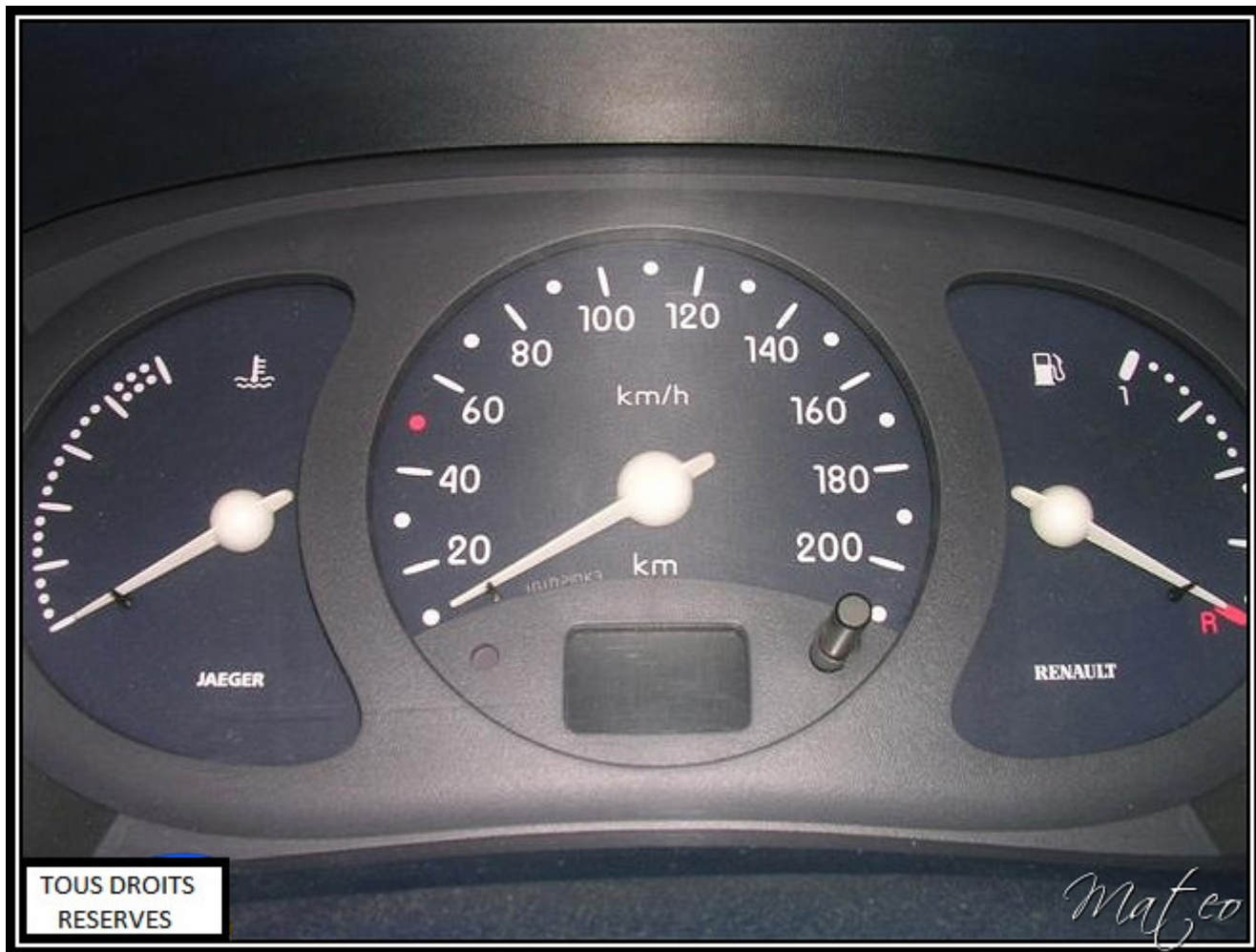
Génération 2 : Éclairage par leds, Fond noir ou blanc, Montage sur Clio 2.1 après Semaine 43 de 1999
